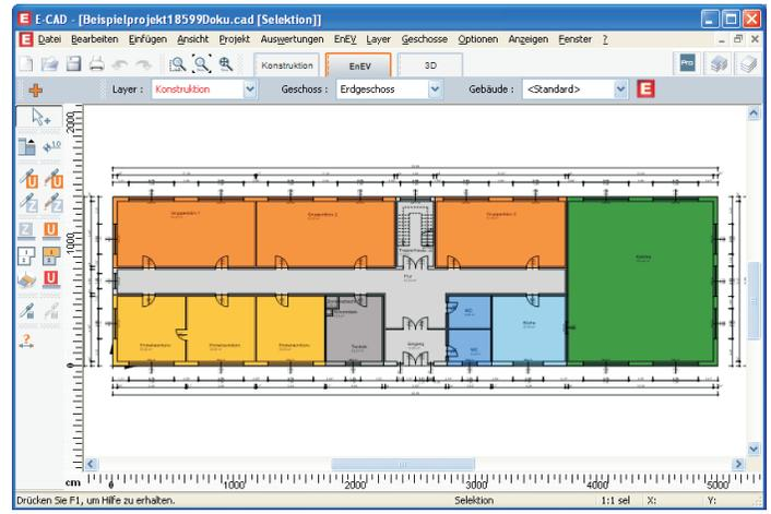
Die Hüllflächendaten, relevante Zwischenwände, Fenster, Fenstermaße, Zonendaten, Volumina und Nettogrundflächen werden an **EnEV-Wärme&Dampf** übergeben und brauchen nur noch um konkrete Schichtaufbauten und Anlagentechnik zu einem EnEV-Nachweis erweitert werden.
