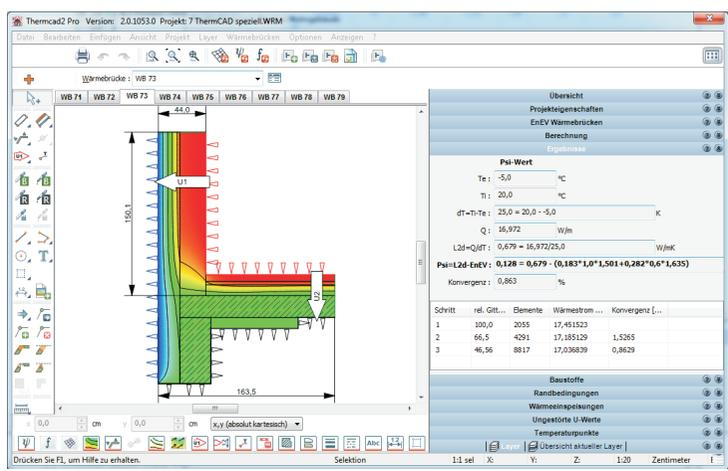
Mit **ThermCad3** lassen sich PSI-Werte von beliebigen Konstruktionsdetails über finite Elemente nach DIN EN ISO 10211-2 berechnen. Der ThermCad-FEM-Netzgenerator arbeitet mit 3 und 4 Ecks Elementen und berücksichtigt automatisch die geforderten Konvergenzkriterien.
